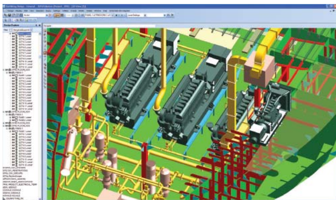
Компоновка машинного зала в AVEVA Marine
