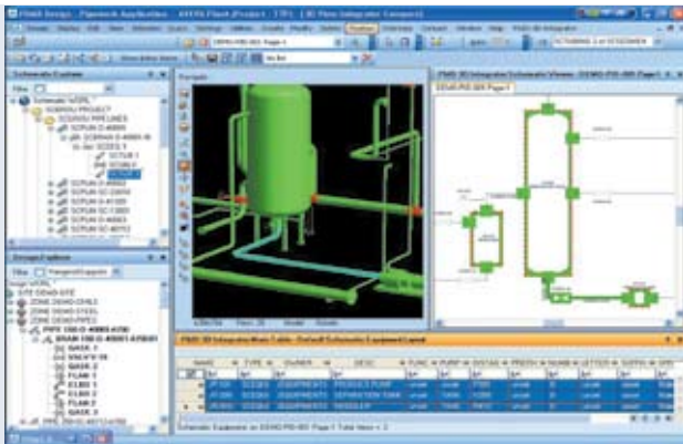
Рис. 3. Взаимодействие данных схемы и 3D-модели
