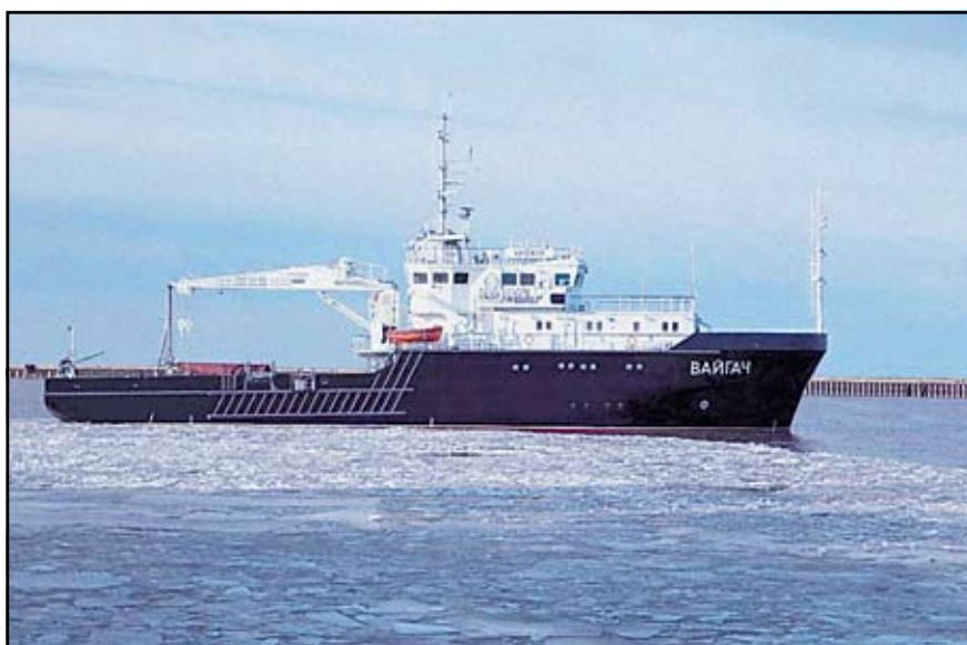
Малое гидрографическое судно: длина – около 57 м; ширина – около 12 м; высота борта – около 6 м; осадка – 3,7 м; мощность гребного электродвигателя – 2S1500 кВт (фото предоставлено ООО “КБ “Вымпел”, проект выполнен в системе TRIBON)
