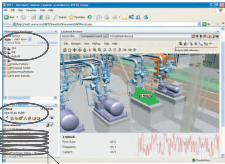
Визуализация трехмерной модели с реальными операционными данными и ссылками на всю необходимую информацию на одной странице.
