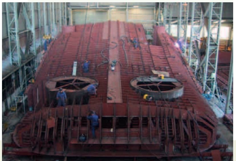
Сверху: Сборка кармового пика блока. Фотография предоставлена Astilleros ARMON Vigo. Слева: 3D модели AVEVA Marine двигателей. Фотография предоставлена Astilleros ARMON Vigo.
