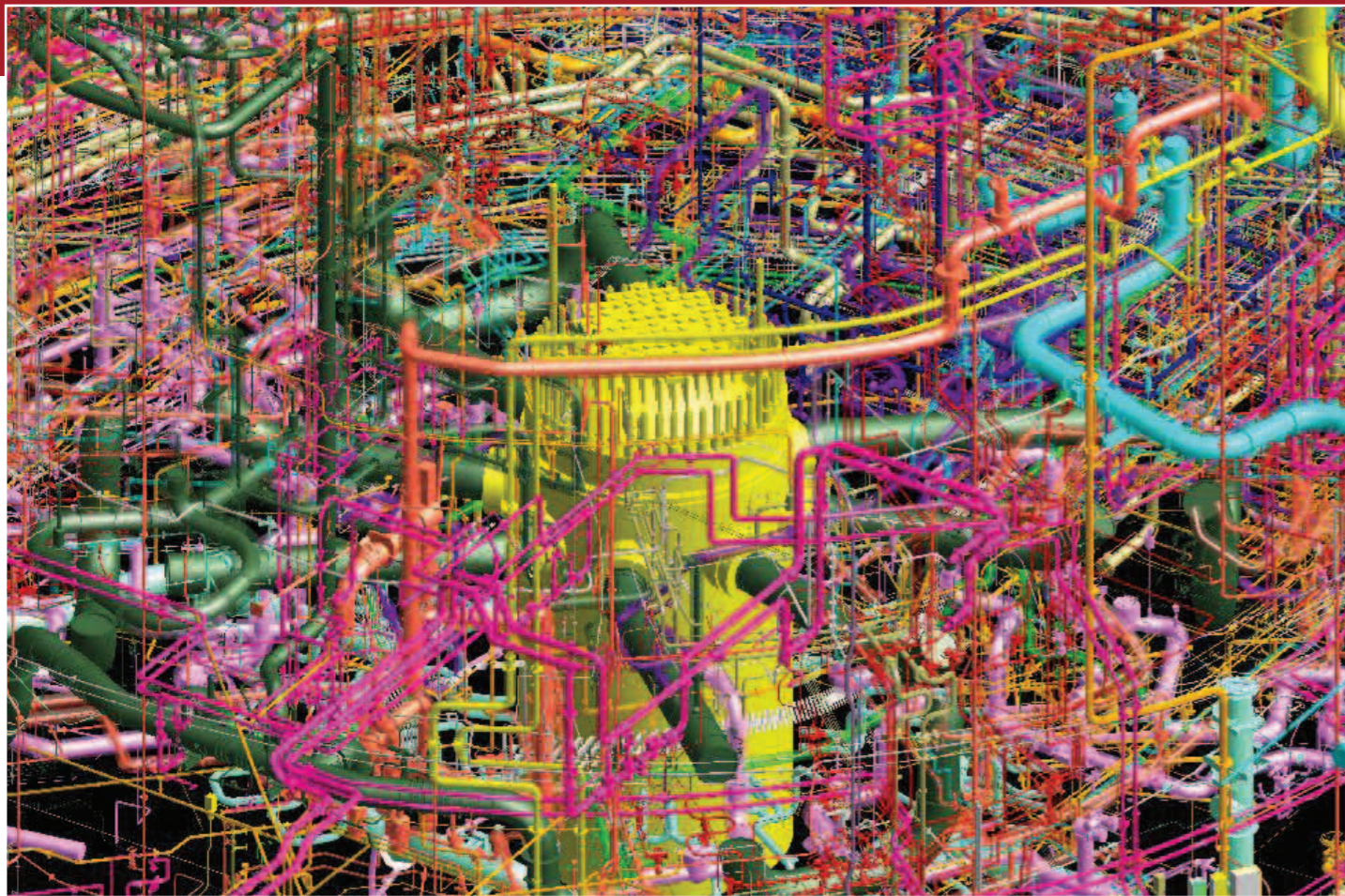
Модель EPR, детально проработанная в трехмерной среде PDMS. Она отображает только системы трубопроводов в конструкции самого реактора, что позволяет получить полное представление об объеме, деталях и сложности проекта. Изображение любезно предоставлено компанией AREVA.
